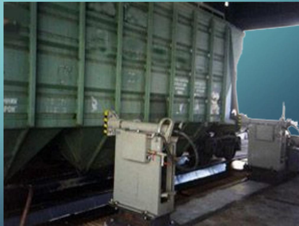
Вагонный разгрузатель - электровибратор ОПТИ-ЛАЙН-42-1-К2 установленной мощностью 1 кВт, с механизмом крепления к боковым силовым элементам хопра-цементовоза с регулировкой частоты вибраций или без регулировки. Вагонный разгрузатель-электровибратор при работе навешивается на боковые стенки хоппера, на силовые вертикальные элементы стенок.
