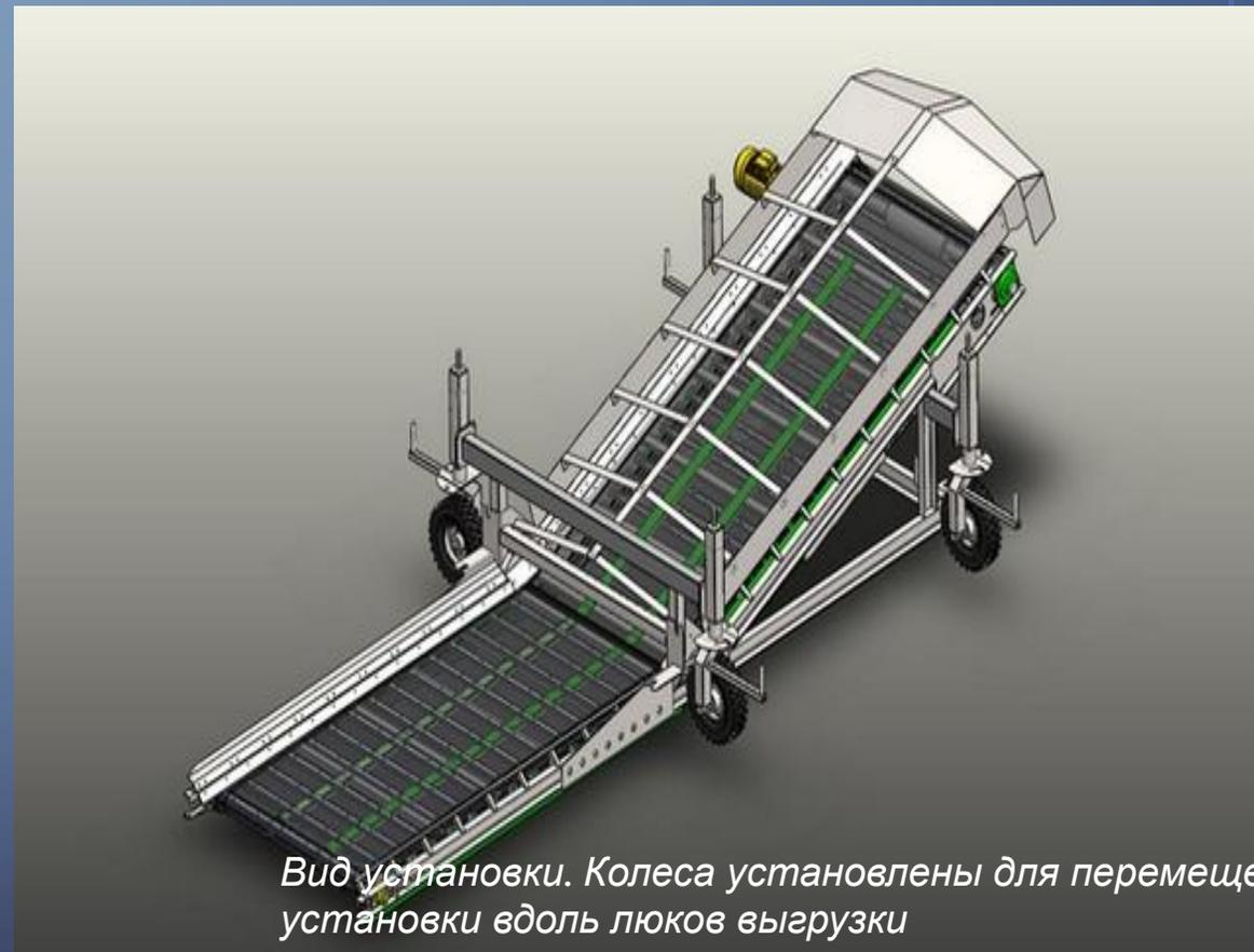
*Вид установки. Колеса установлены для перемещения установки вдоль люков выгрузки*
