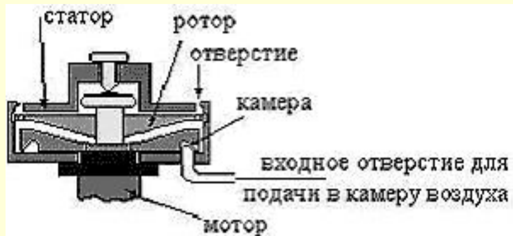
Механический ультразвуковой преобразователь
