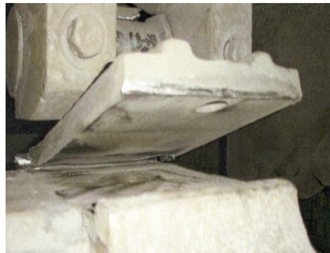
Отрыв кронштейна тягового двигателя от корпуса
