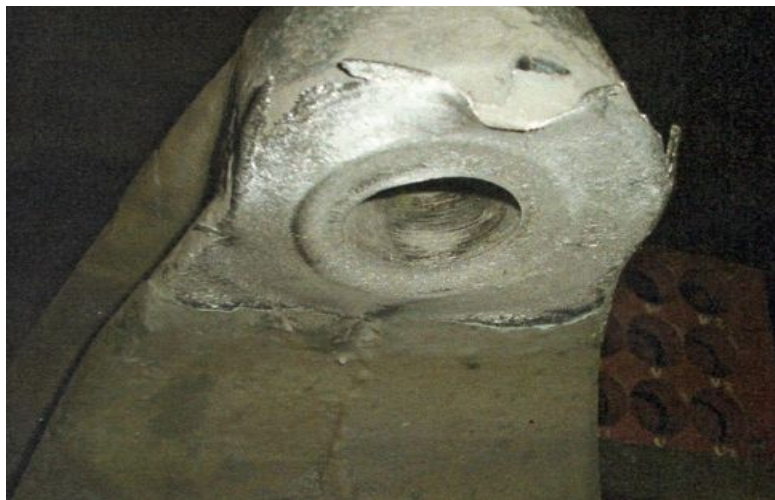
Кронштейн тягового двигателя и детали опоры на концевую балку
