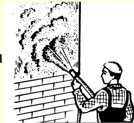
3. Во время нанесения обрызга и грунта форсунки держат к оштукатуриваемой поверхности под углом 60....90 градусов, при нанесении обрызга и грунта по дроби – под углом 60 градусов.
