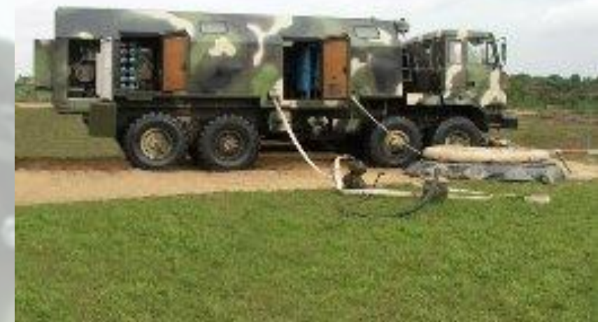
Станция комплексной очистки и опреснения воды СКО-10/5
