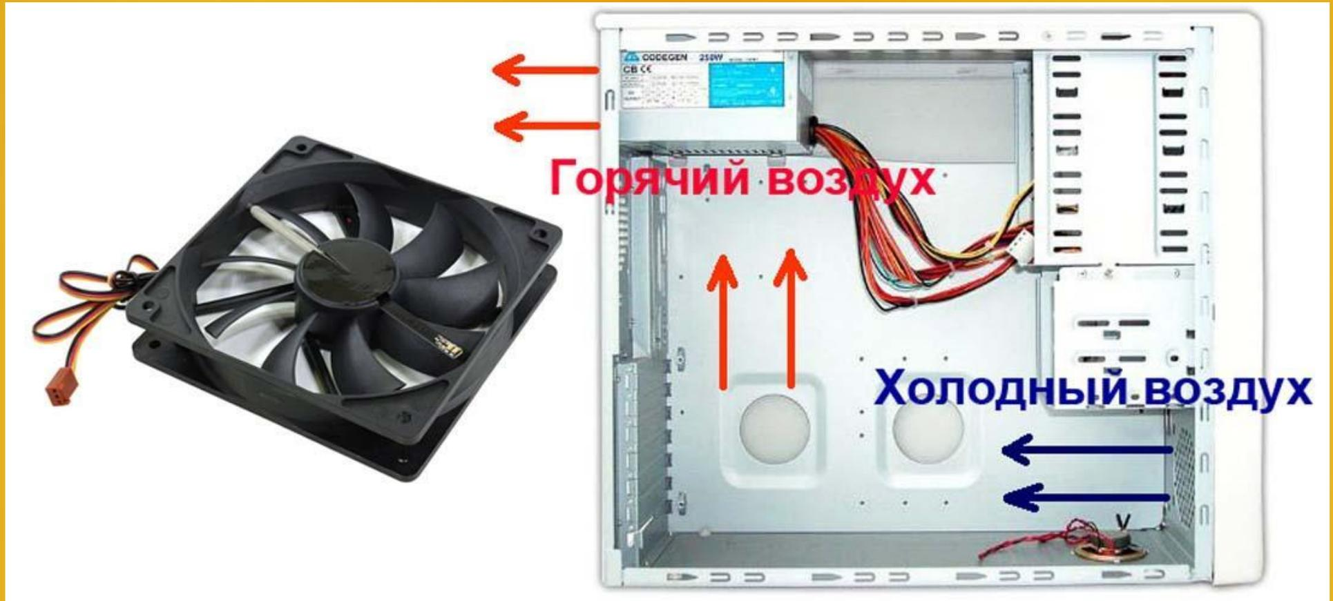
Система охлаждения – это система из вентиляторов, которая служит для отвода теплого воздуха с компонентов системного блока и подачи холодного воздуха из внешней среды.
