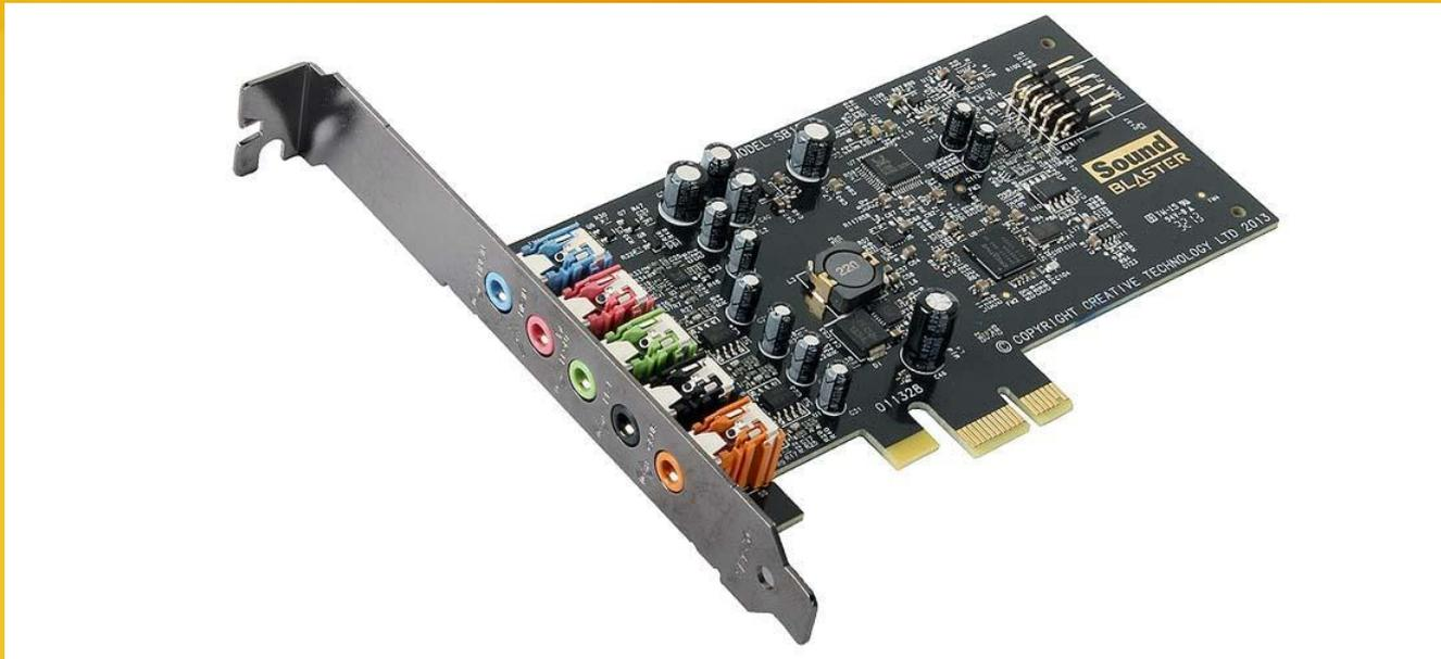
Звуковая карта – обработка и вывод звука на динамики компьютера. Бывают случаи, когда встроенная звуковая карта выходит из строя или пользователя не устраивает качество звучания композиций, тогда устанавливают внешнюю звуковую карту.
