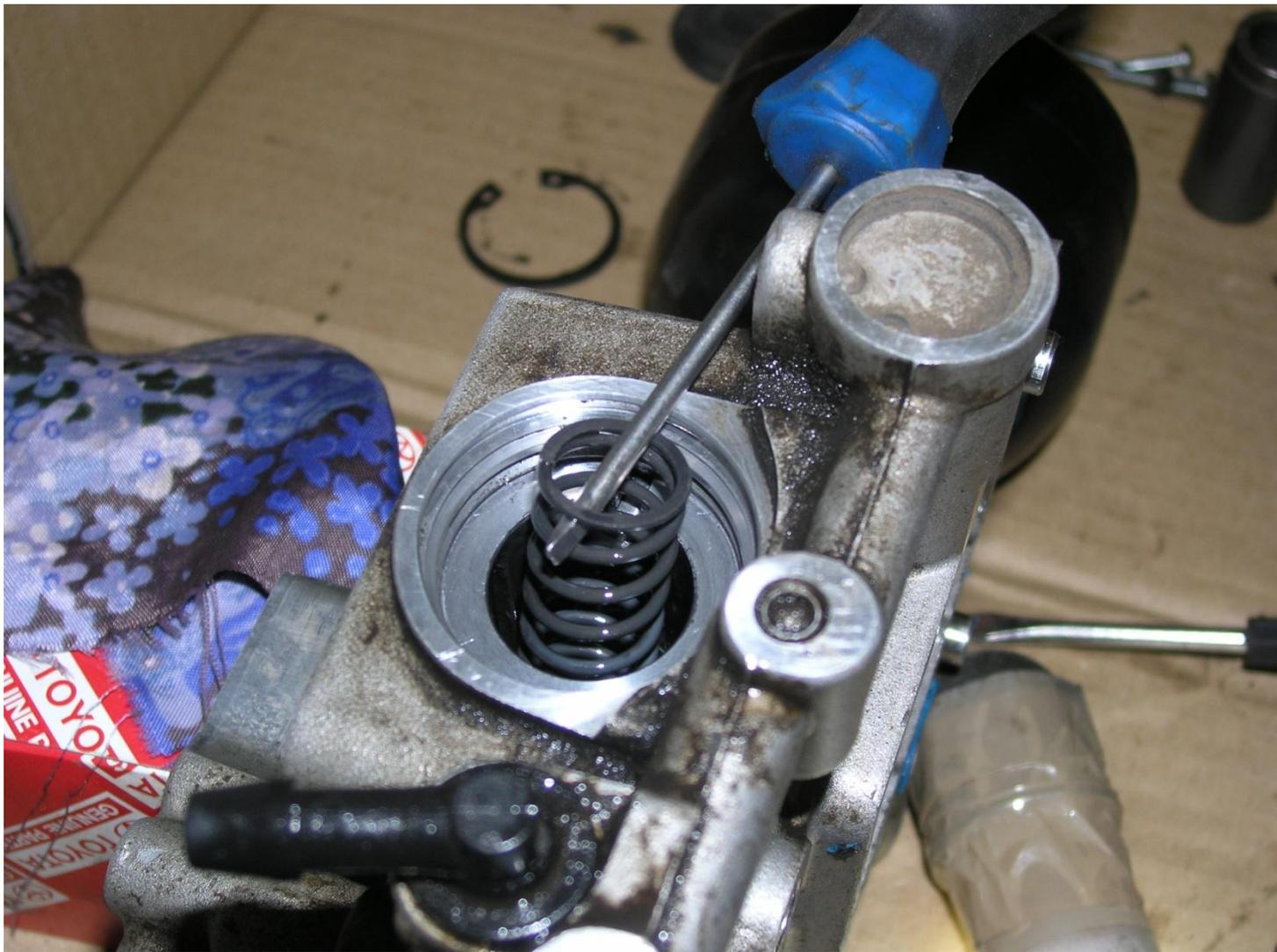
5. Извлекаем пружину поршня
