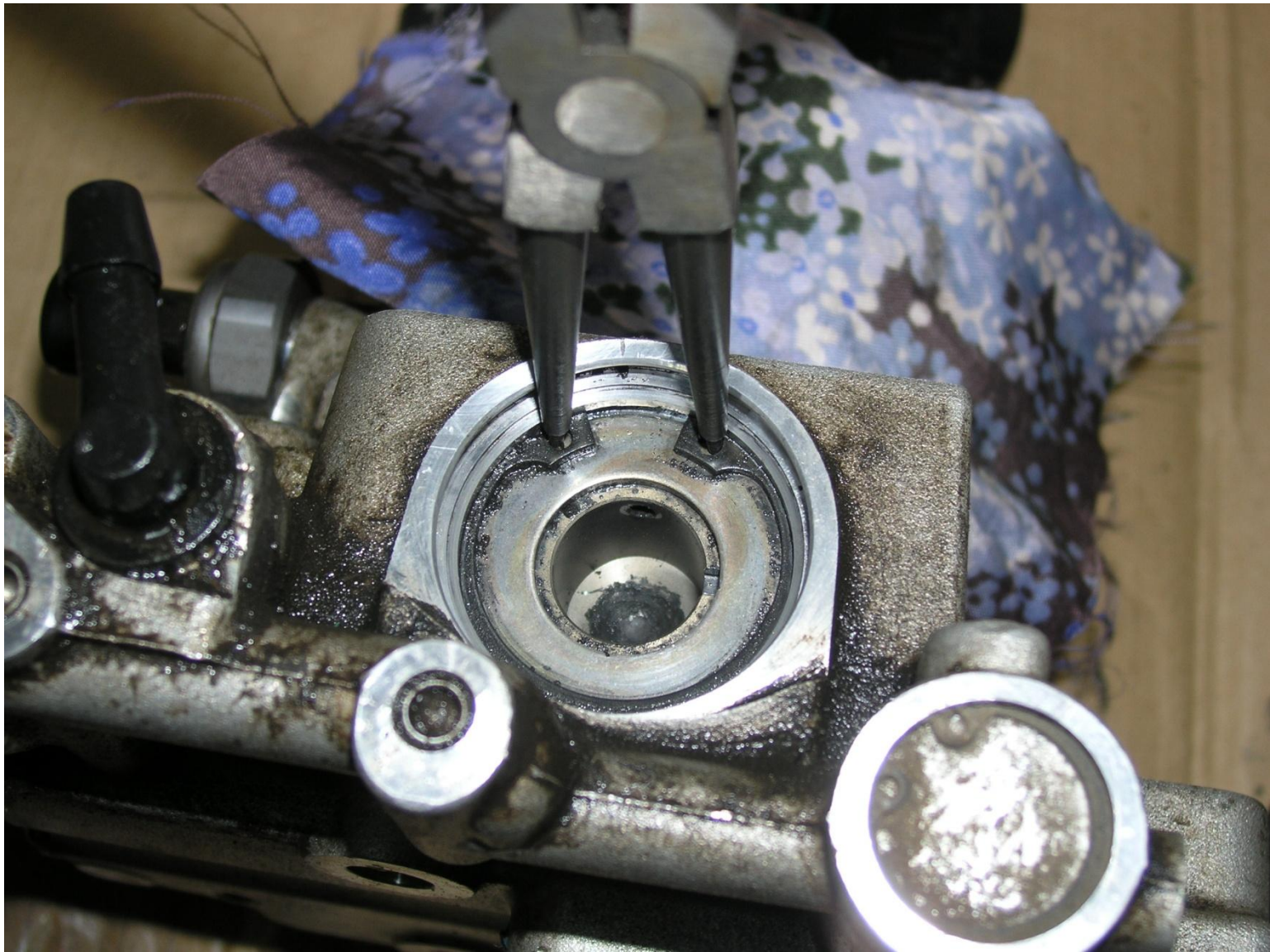
3. Удаляем стопорное кольцо
