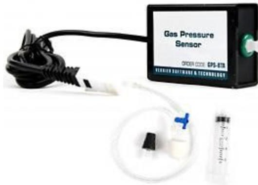
Датчик предназначен для измерения давления во время физических и химических экспериментов с газами. Также можно измерять давление пара различных жидкостей и растворов. В биологии с помощью датчика можно наблюдать за производством или потреблением кислорода и углекислого газа в закрытом пространстве.
