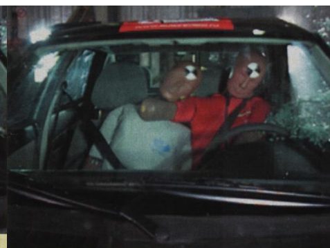
Через 82 мсек «пассажир» наклоняется влево и его шея ломается о подставленное «плечо водителя»
