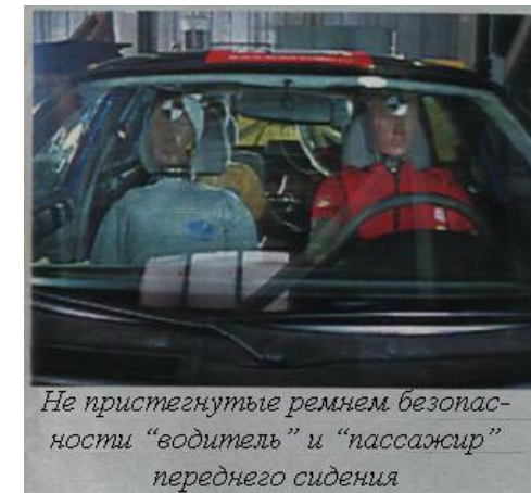
Через 42 мсек «водитель» ударяется о дверь, «пассажир» всем телом съезжает вбок по инерции
