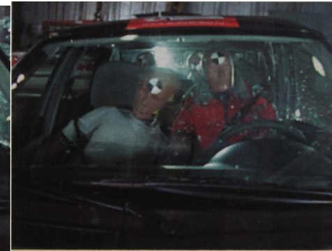
По завершении активной фазы удара «пассажир» пытается поднырнуть обратно под ремень безопасности
