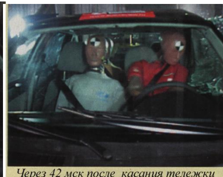
Через 42 мсек после касания тележки «водитель» приложился о накладку стойки, а «пассажир» начал выскользывать из-под ремня безопасности
