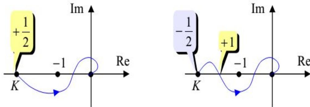
Частотная характеристика начинается на вещественной оси левее точки  $(-1; 0)$ . На рисунке слева годограф сначала идет вниз (половина положительного перехода) и больше нигде не пересекает ось абсцисс левее точки  $(-1; 0)$ , поэтому разница переходов равна  $1/2 = \ell/2$  и замкнутая система устойчива.
