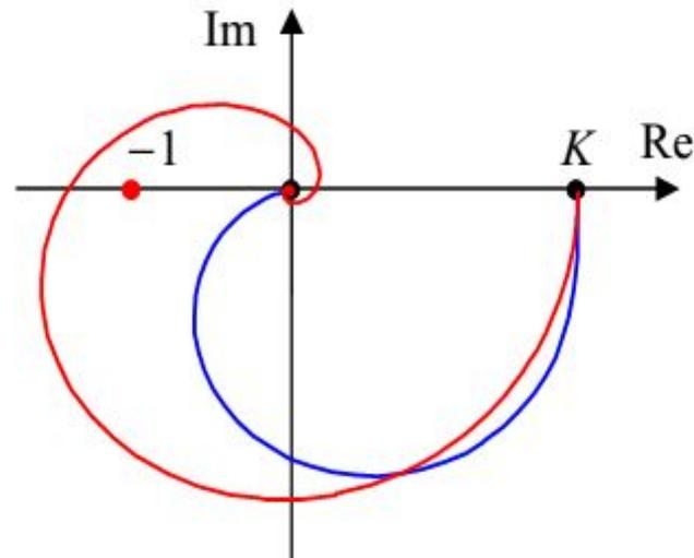
На рисунке синяя линия – частотная характеристика системы без запаздывания, а красная – аналогичная характеристика для системы с запаздыванием. Видно, что запаздывание привело к неустойчивости системы (годограф охватил критическую точку  $(-1; 0)$ ). Таким образом, система может потерять устойчивость из-за «медленного» датчика. Можно говорить о том, что *запаздывание всегда ухудшает устойчивость системы*, и этот факт важно учитывать при проектировании.
