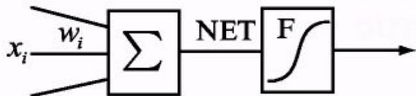
НПЭ состоит из взвешенного сумматора и нелинейного элемента. Функционирование определяется формулами:
