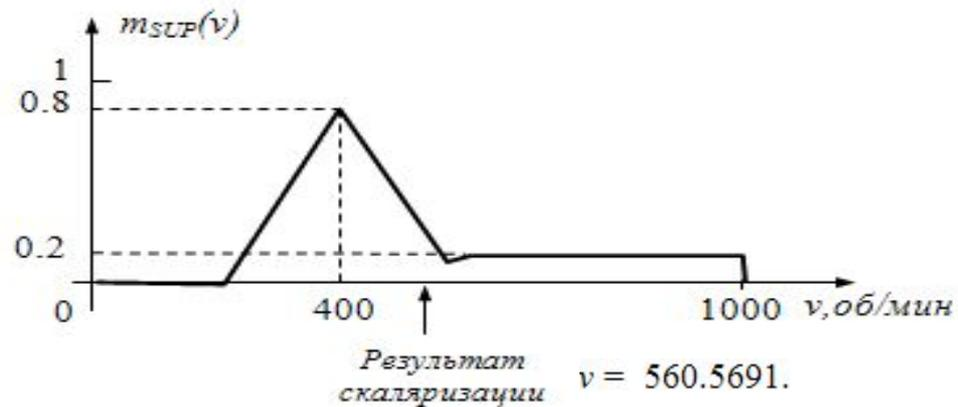
Получение скалярного значения скорости вращения вентилятора методом «центра тяжести» для  $t = 22^\circ\text{C}$
