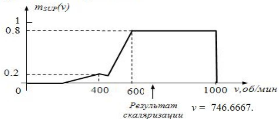
Получение скалярного значения скорости вращения вентилятора методом «центра тяжести» для  $t = 28^\circ\text{C}$
