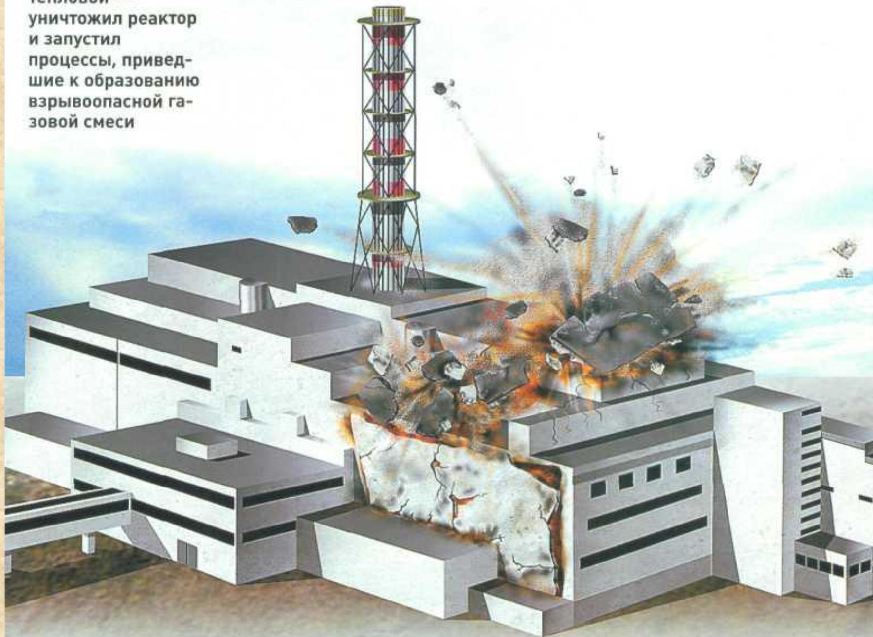
Второй взрыв — смеси водорода с воздухом — разрушил здание 4-го блока
