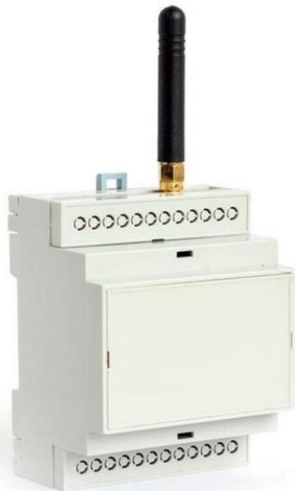
LPWAN модем подключается к однофазному или трёхфазному электросчётчику с цифровым выходом (**RS-232** или **RS-485**). Устройство работает от встроенного источника питания D-типа повышенной ёмкости не подверженному саморазряду. В модеме заложена возможность удалённого управления электросчётчиком (полезно в случае необходимости дистанционного включения и отключения потребителей). Модем передаёт информацию о нештатных ситуациях и попытках вскрытия счётчика
