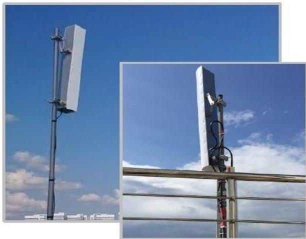
Базовая станция – стационарная радиостанция, специализированная для решения телематических задач и использующая узкополосный беспроводной протокол.
