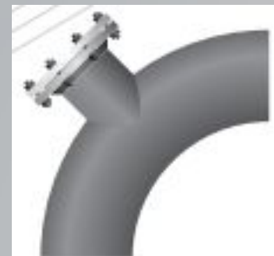
Врезка в отвод
