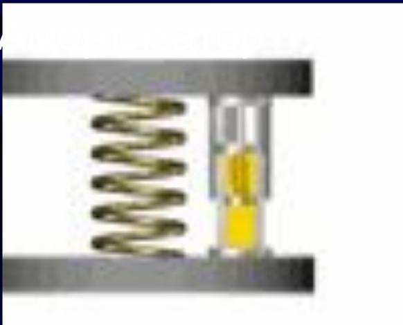
– Амортизатор - гаситель колебаний - устройство в конструкциях машин, сооружений для защиты их от сотрясений
