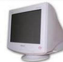
**Монитор** является универсальным устройством для передачи информации. В настольных компьютерах до сих пор используются *мониторы на электронно-лучевой трубке*. Но такие мониторы могут являться источником вредных для человека излучений. Современные мониторы соответствуют санитарно-гигиеническим требованиям. В современных настольных, портативных и карманных компьютерах применяют *плоские мониторы на жидких кристаллах*, преимущество которых состоит в отсутствии вредных излучений и компактности.
