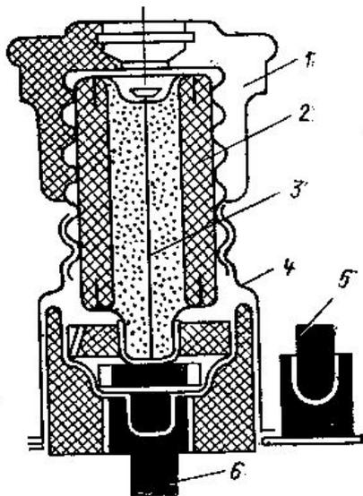
Пробочные предохранители типа ПДС
