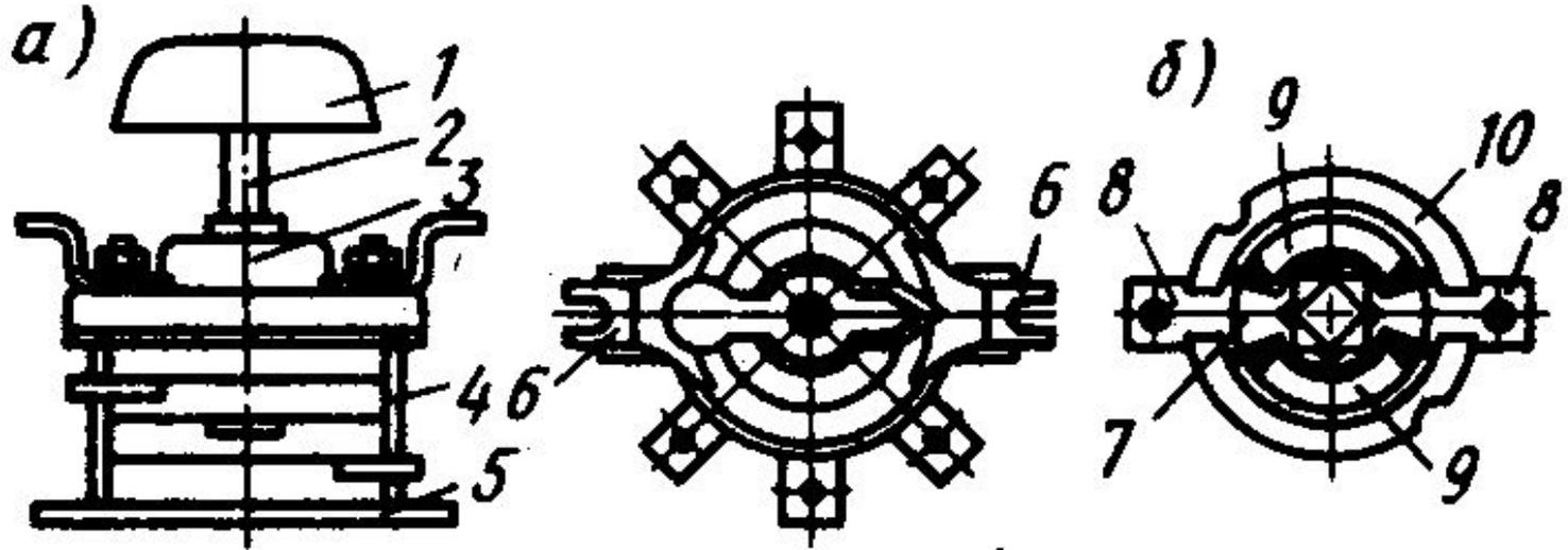
Пакет контактной системы (а) и общий вид пакетного выключателя (б):
