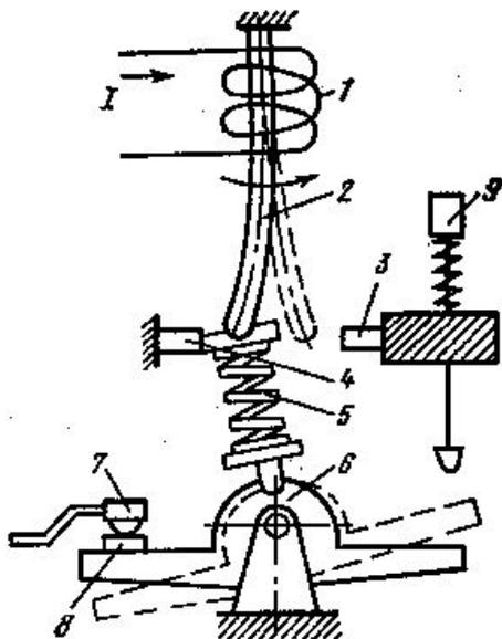
Принцип работы теплового реле:
