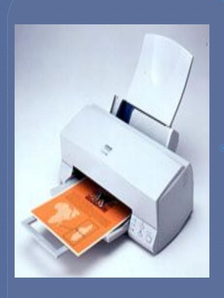
В струйных принтерах изображение формируется микрокаплями специальных чернил, выдуваемых на бумагу с помощью форсунок, расположенных в печатающей головке. Современные струйные принтеры обеспечивают высокое качество печати, приближающееся к качеству печати лазерных принтеров. Цветные модели струйных принтеров позволяют сформировать достаточно качественное цветное изображение.
