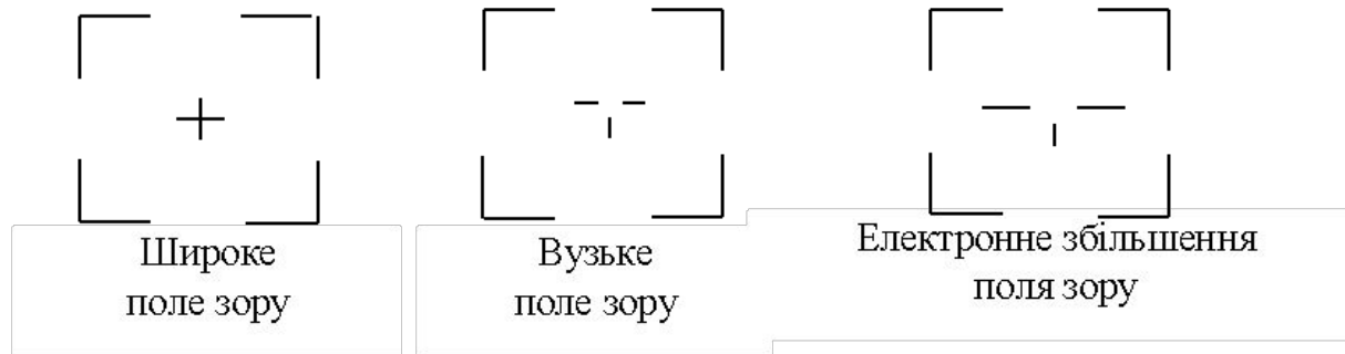
Рисунок 1 – Вигляд "ВІКНА" і прицільної марки у ручному режимі спостереження за ціллю Під час роботи в режимі "TV CAMERA" (ПНТ)
