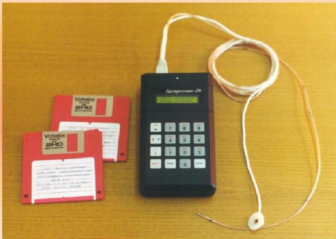
Измеряет и запоминает значения рН в 3-х точках ЖКТ у одного пациента с периодичностью 1 раз в 20 секунд в течение 24 часов. Затем все данные обрабатываются на компьютере и хранятся в базе данных.
