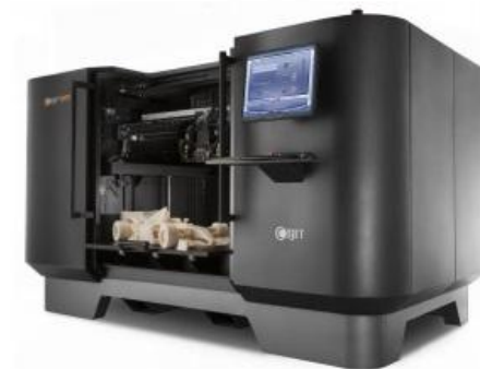
Промышленный принтер Objet 1000; область построения 1000*800*500 мм
