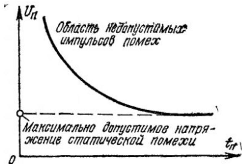
Рис. 4.2. Характеристика динамической помехоустойчивости логической микросхемы
