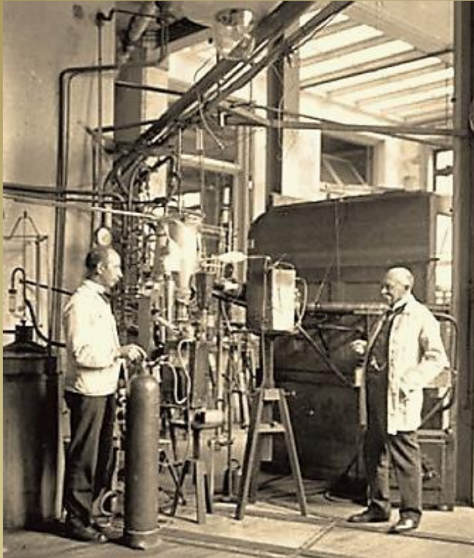
12 СТЕКЛЯННЫХ ДИФфуЗИОННЫХ НАСОСОВ ДЛЯ ОТКАЧКИ ЖИДКОГО ГЕЛИЯ
