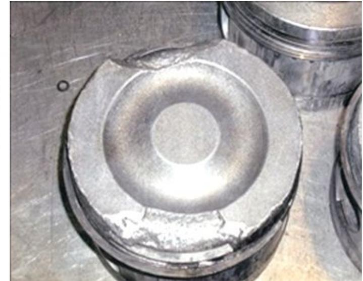
в. Детонационная эрозия поршня газового двигателя при длительной работе на попутном газе с низким МЧ (ОЧМ).
