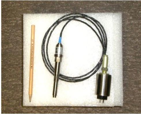
Датчик давления в цилиндре
