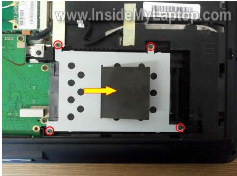
Извлеките жесткий диск в сборе из корпуса ноутбука. Теперь при необходимости можно извлечь жесткий диск из лотка и заменить его новым. Как видно, это диск с интерфейсом SATA.
