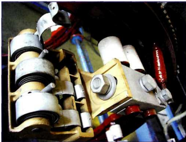
Рис. 20. Крепление узла щеткодержателя
