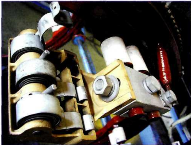
Рис. 20. Крепление узла щеткодержателя
