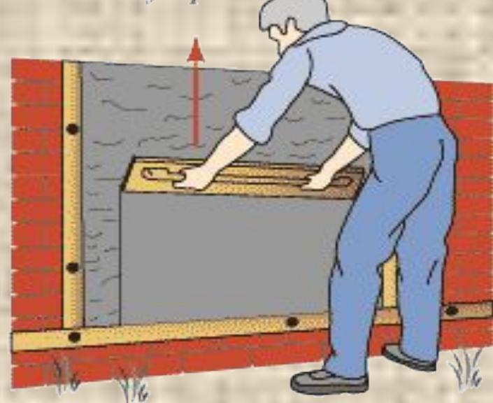
Грунт разравнивают сглаживанием или срезыванием. Заполнив пространство между маяками, следует разровнять раствор полутерком. Следите за тем, чтобы в растворе не оставалось пузырьков воздуха и покрытие плотно прилегало к стене. Движения полутерка могут быть зигзагообразные: короткие — слева направо и справа налево, длинное — вверх и немного в сторону.
