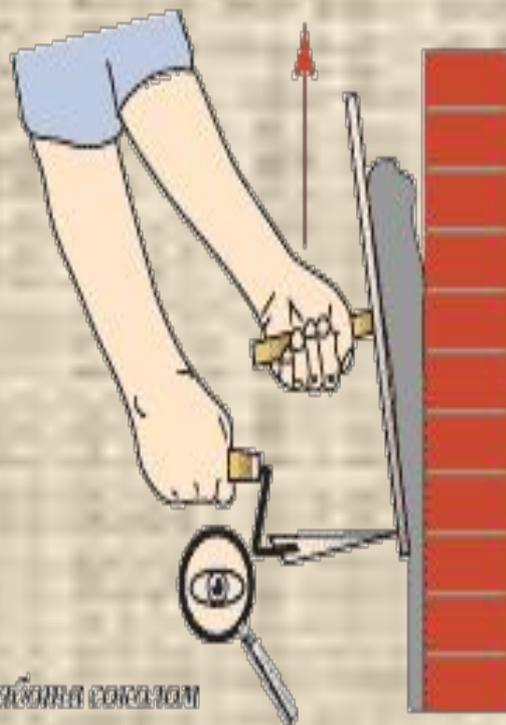
На сокол нажимают концом мастерка, упертым под шпонку сокола, и перемещают его. По мере продвижения сокола раствор намазывается на поверхность, а приподнятый второй край сокола постепенно прижимается к ней. При соответствующем навыке разравнивать соколом раствор можно очень ровно.
