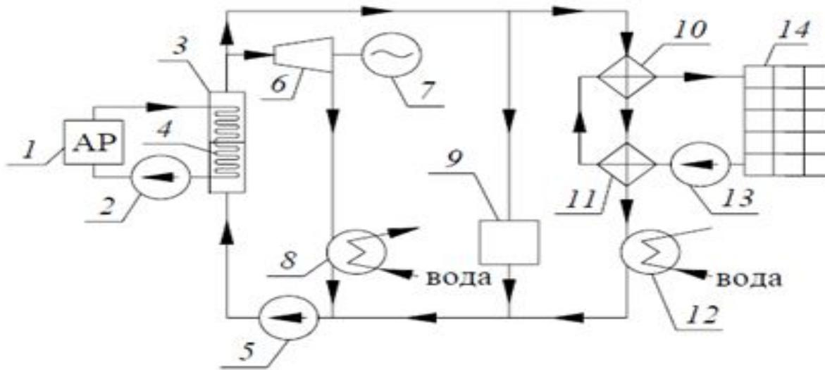
1 – атомный реактор; 2 – циркуляционный насос; 3 – парогенератор; 4 – змеевики парогенератора; 5 – питательный насос; 6 – паровая турбина; 7 – электрогенератор; 8, 12 – конденсатор; 9 – технологическое производство; 10, 11 – паровые подогреватели; 13 – сетевой насос; 14 – потребитель
