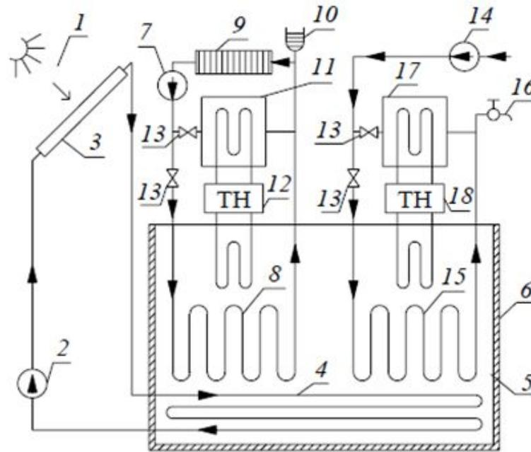
1 – энергия Солнца; 2 – насос; 3 – коллектор солнечной энергии; 4 – теплообменник; 5 – бак-аккумулятор; 6 – тепловая изоляция; 7 – насос системы отопления; 8, 15 – теплоприемники; 9 – радиаторы; 10 – воздухооборник; 11, 17 – промежуточный бак; 12, 18 – тепловой насос; 13 – вентили; 14 – насос горячего водоснабжения; 16 – кран горячей воды
