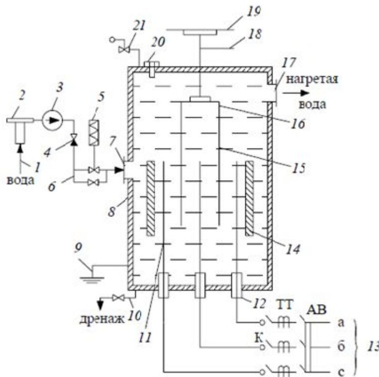
Рис. 4. Принципиальная схема электродного водогрейного котла
