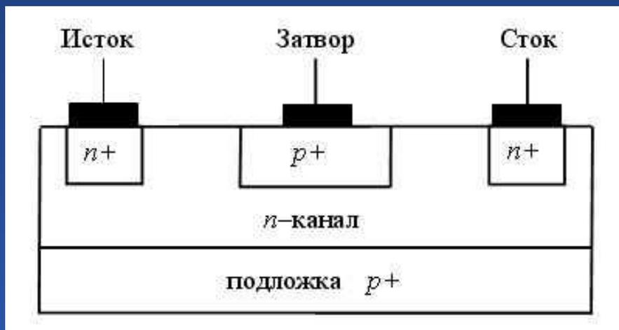
Структура полевого транзистора с управляющим  $p-n$ -переходом
