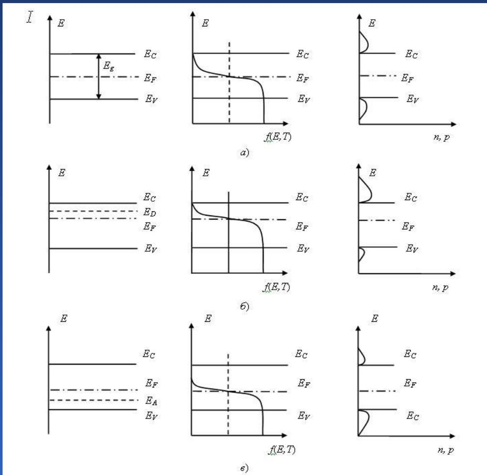
Зонная диаграмма, функция распределения Ферми – Дирака и концентрация носителей в собственном полупроводнике (а), в полупроводнике  $n$ -типа (б) и в полупроводнике  $p$ -типа (в)
