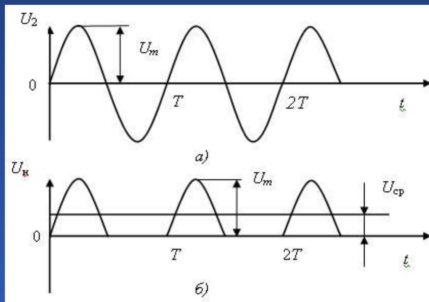
Форма напряжений на входе (а) и выходе (б)
