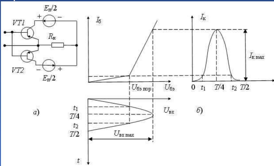
Принципиальная схема двухтактного усилителя мощности (а) и временные диаграммы (б), поясняющие ее работу (VT1 – n–p–n, VT2 – p–n–p)
