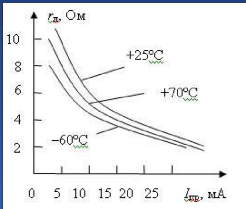
Зависимость дифференциального сопротивления диода ГД402
