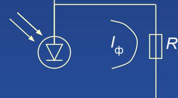
Схема включения фотоэлемента
