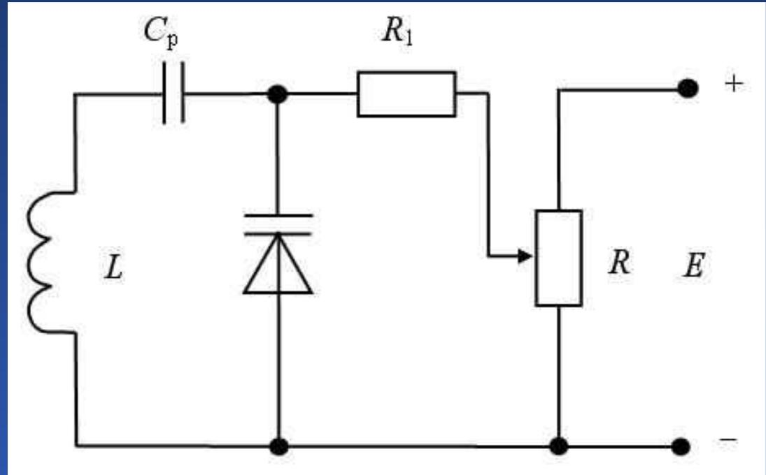
Схема включения варикапа
