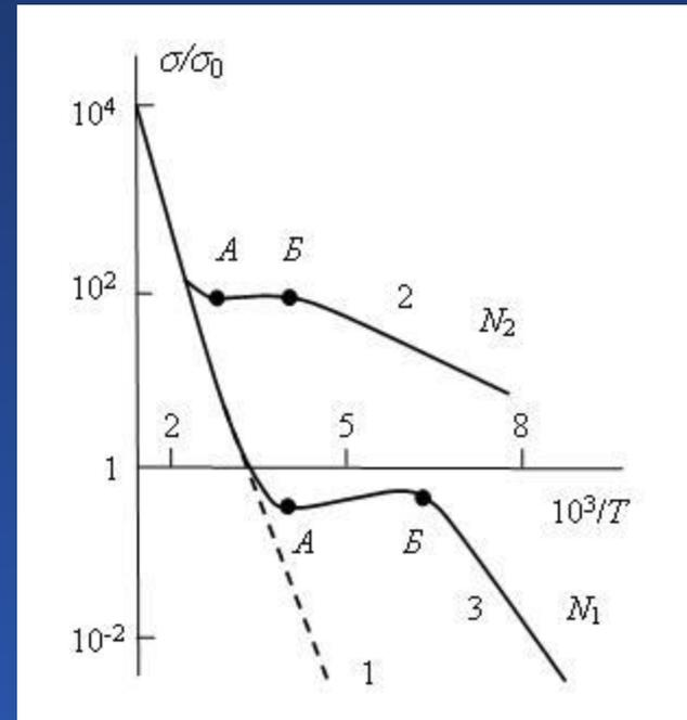
Зависимость относительной удельной проводимости кремния от температуры:
