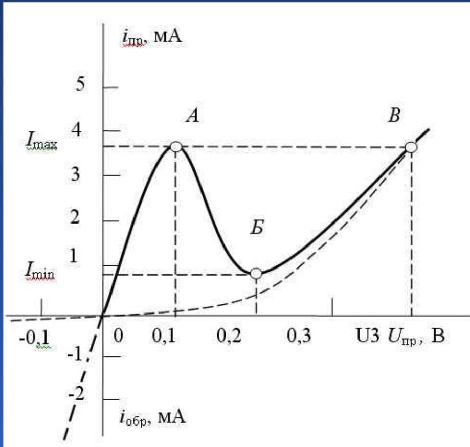
В точке Б получается минимум тока и характеристика имеет *падающий* участок АБ, для которого характерно отрицательное сопротивление переменному току
