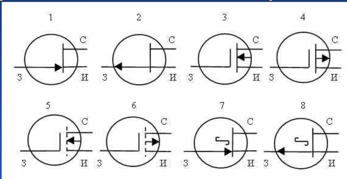
Условные обозначения различных типов полевых транзисторов (И – исток, С – сток, З – затвор): 1, 2 – транзисторы с управляющим  $p-n$ -переходом (1 – с  $n$ -каналом, 2 – с  $p$ -каналом); 3, 4 – МОП-транзисторы со встроенным каналом (3 – с  $n$ -каналом, 4 – с  $p$ -каналом); 5, 6 – МОП-транзисторы с индуцированным каналом (5 – с  $n$ -каналом, 6 – с  $p$ -каналом); 7, 8 – транзисторы с барьером Шоттки (7 – с  $n$ -каналом, 8 – с  $p$ -каналом)
