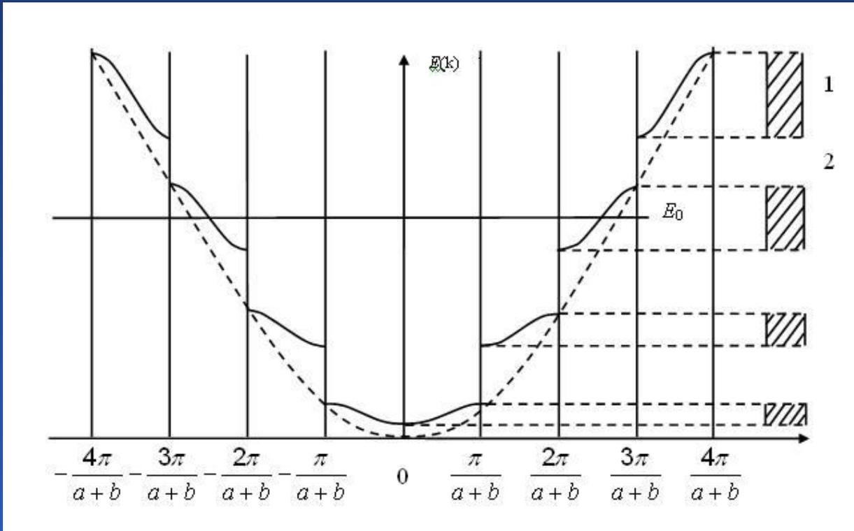
Зависимость энергии  $E(k)$  электрона от волнового вектора  $k$  в потенциале Кронига – Пенни (сплошная линия). Пунктирной линией показана зависимость  $E(k)$  для свободного электрона. 1 – разрешенная зона; 2 – запрещенная зона
