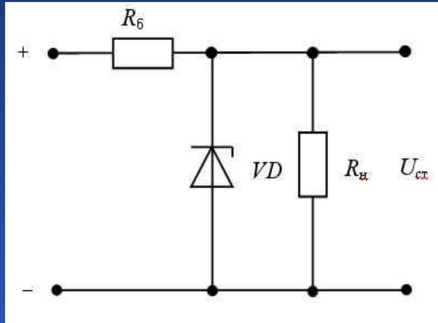
Схема включения стабилитрона:
