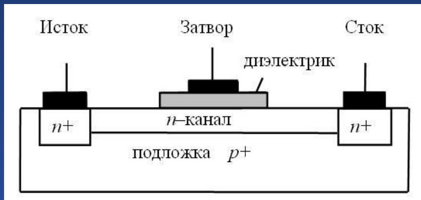
Структура МОП-транзистора со встроенным  $n$ -каналом
