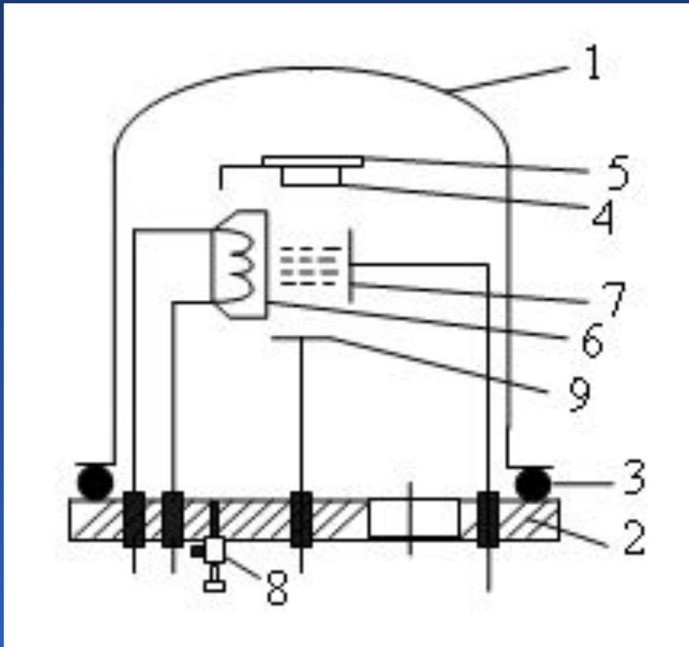
Схема установки ионно-плазменного напыления
