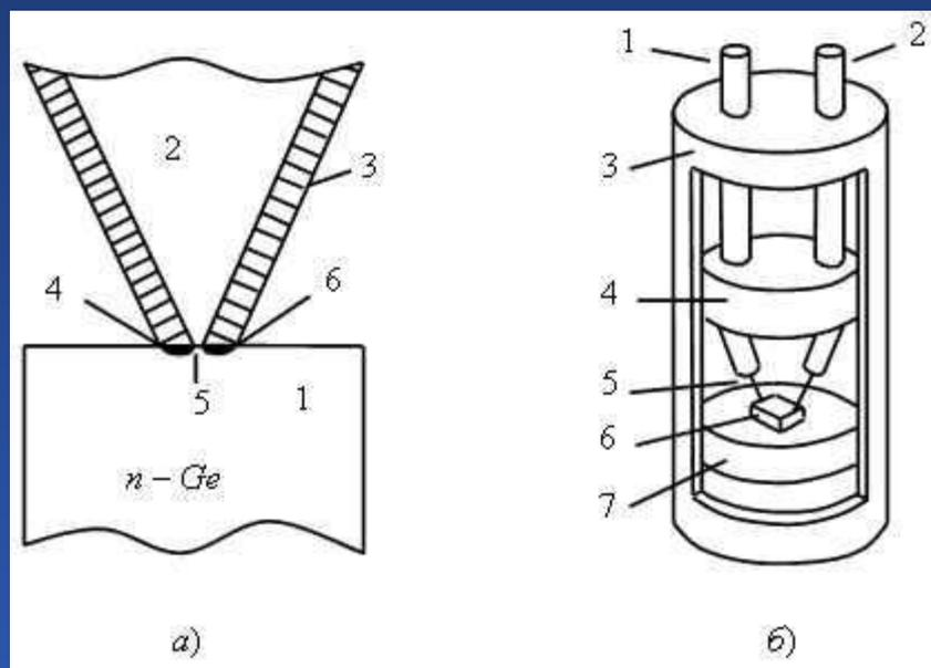
Конструкция первого биполярного транзистора (а) и первый промышленный образец (б)
