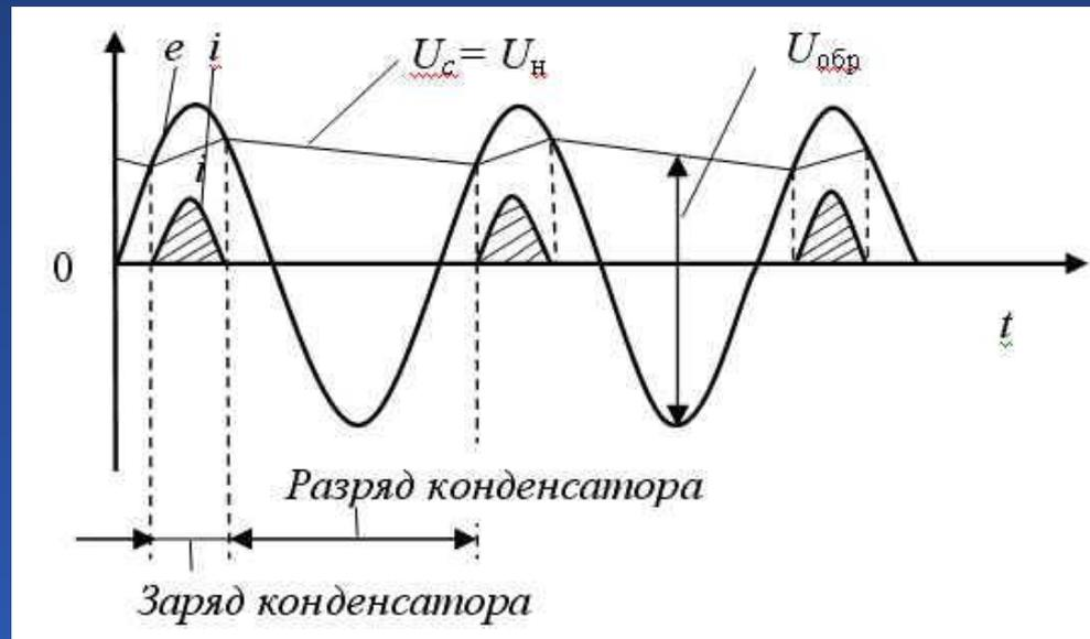
Рис. 2.14. Сглаживание пульсаций
