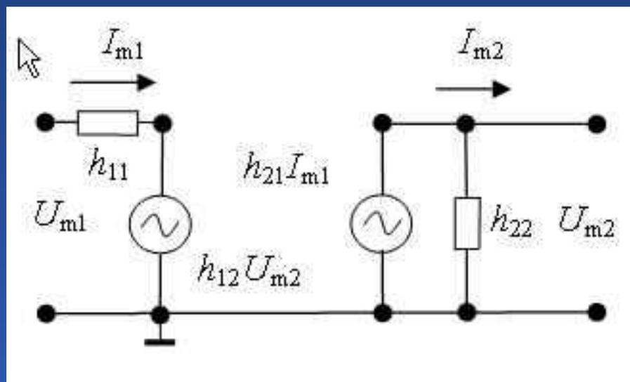
Эквивалентная схема транзистора с использованием  $h$ -параметров
