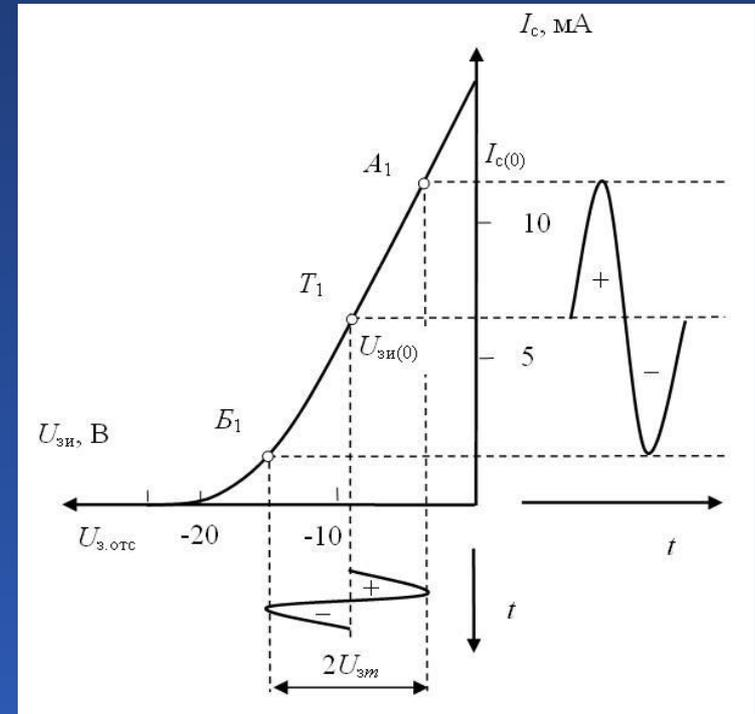
К графоаналитическому расчету и анализу режима усиления полевого транзистора с управляющим  $p-n$ -переходом
