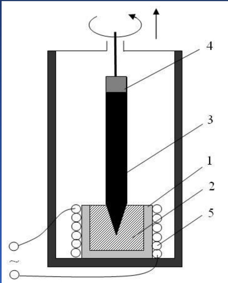
Схема выращивания монокристаллов методом Чохральского: 1 – тигель; 2 – расплав полупроводника; 3 – монокристалл выращиваемого полупроводника; 4 – затравка; 5 – катушка высокочастотного индуктора
