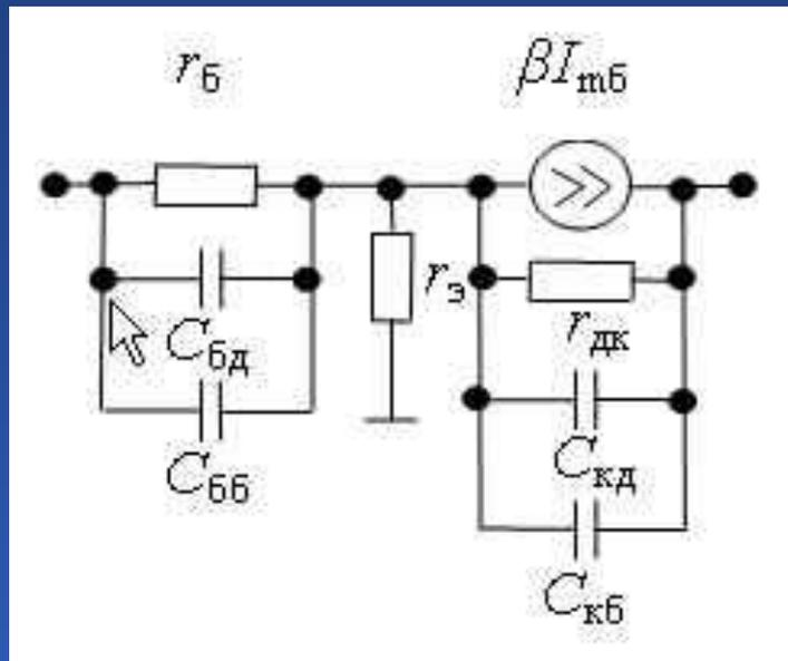
Эквивалентная Т-образная схема биполярного транзистора для области высоких частот
