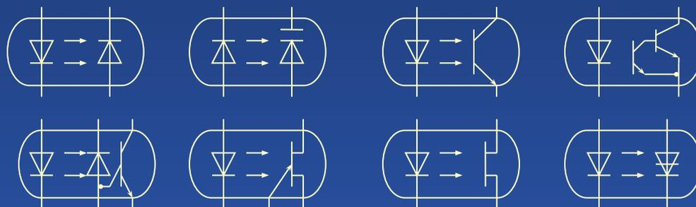
Оптопары с открытым оптическим каналом:
