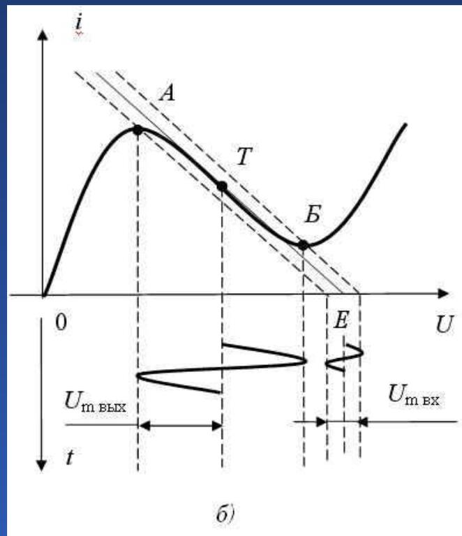
Простейшая схема усилителя с туннельным диодом (а) и график, поясняющий процесс усиления (б)
