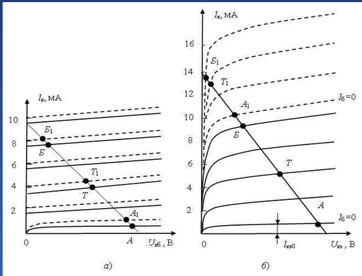
Влияние температуры на выходные характеристики транзистора при включении его по схеме ОБ (а) и ОЭ (б)
