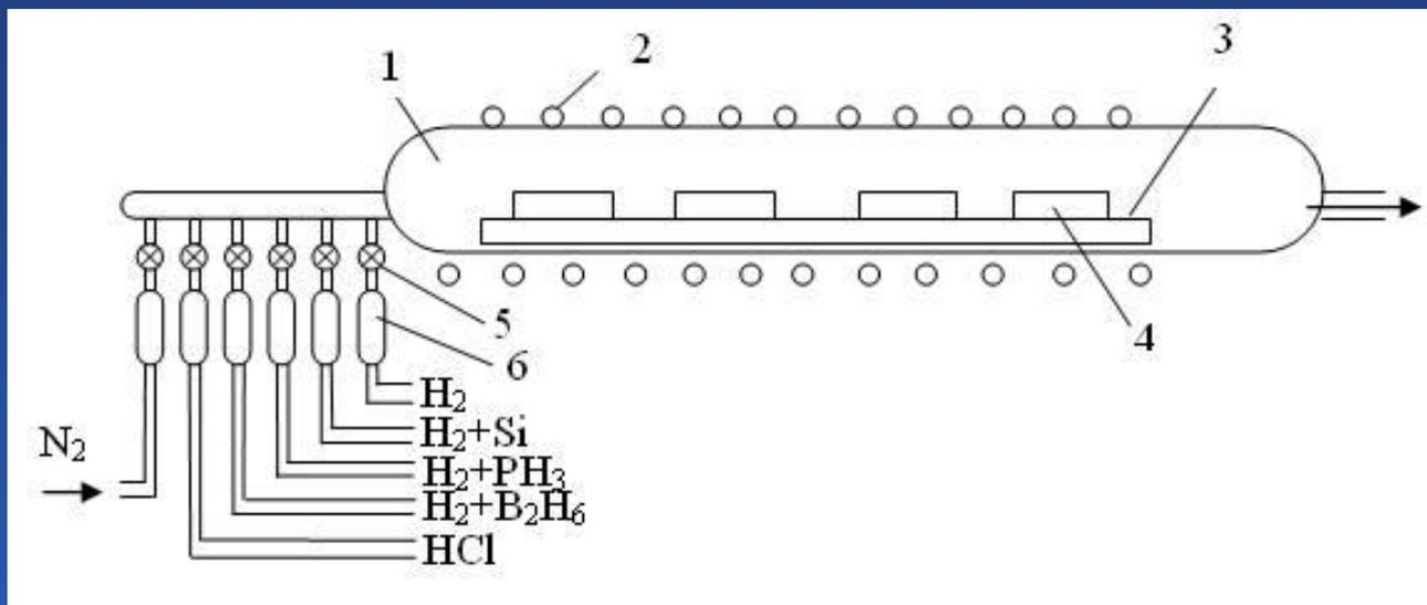
Схема хлоридного процесса эпитаксии: **1** – кварцевая труба; **2** – катушка ВЧ-нагрева; **3** – тигель с пластинами; **4** – пластина кремния; **5** – вентиль для перекрытия соответствующего газа; **6** – измеритель скорости потока
