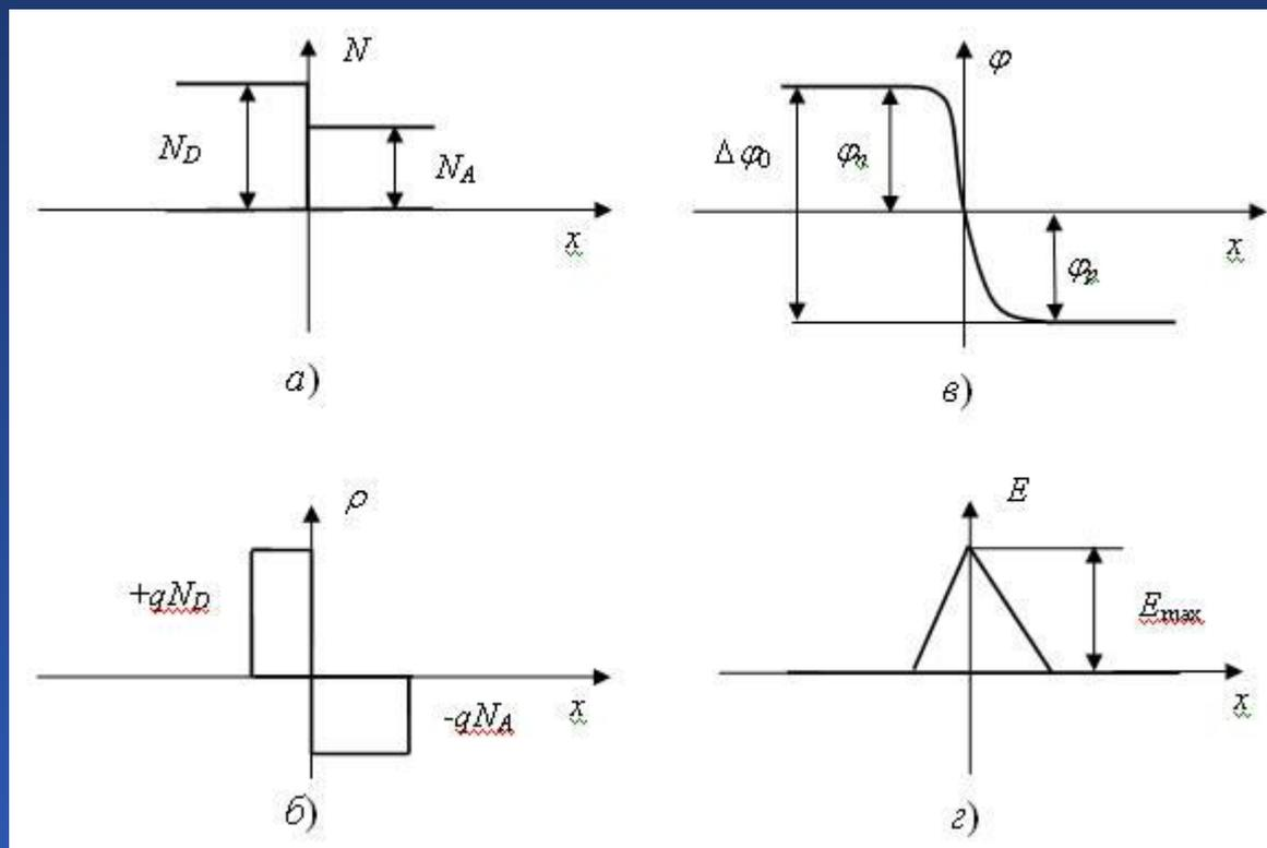
Распределение концентрации примесей (а), плотности объемного заряда (б), потенциала (в) и напряженности поля (г) в ступенчатом  $n$ – $p$ -переходе
