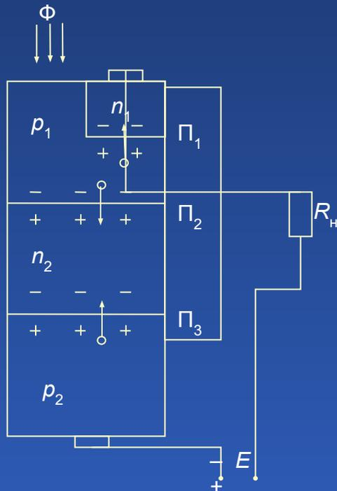
Структура и схема включения фототиристора
