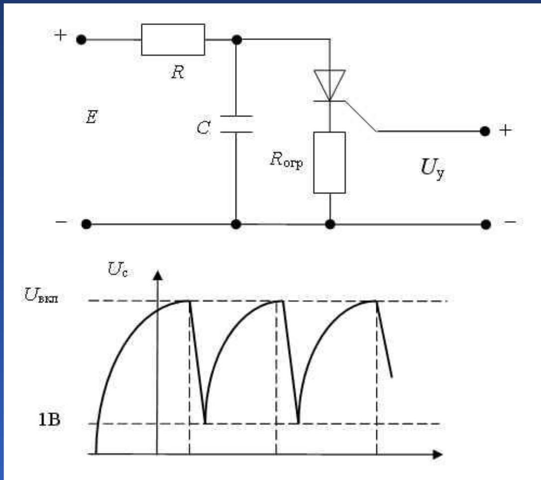
Генератор пилообразного напряжения с тиристором
