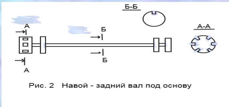
Рис. 2 Навой - задний вал под основу
