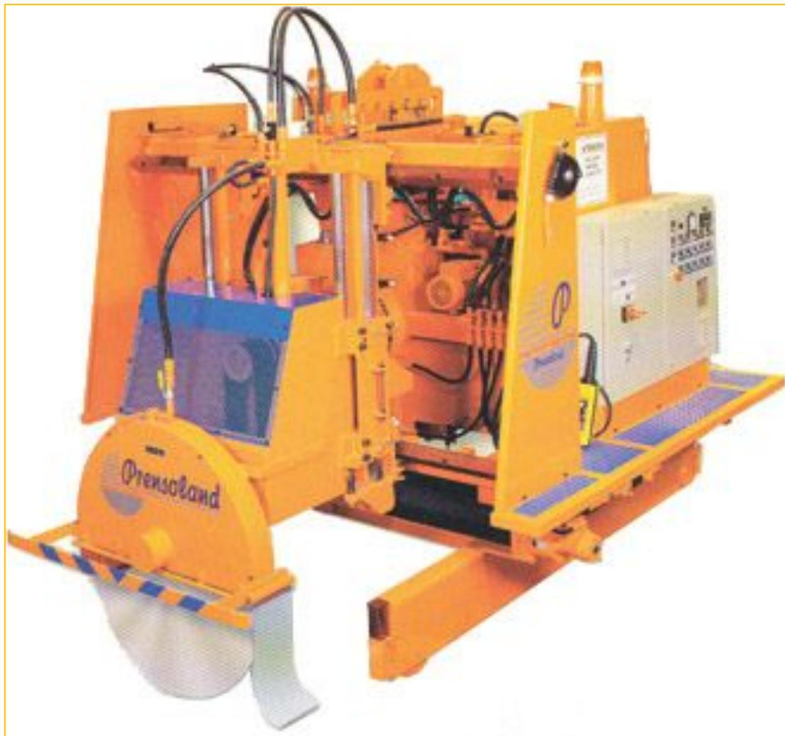
**Максимальная толщина резки 300 мм с диском 900 мм.
