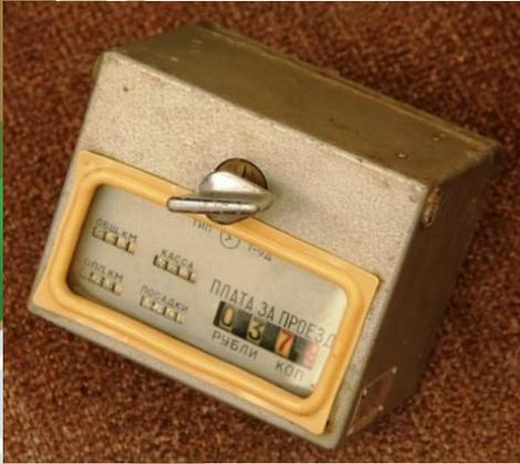
Принцип работы таксометра заключается в измерении расстояния, пройденного автомобилем, и умножении на постоянную величину, задаваемую при программировании таксометра (обычно это стоимость одного километра пути).
