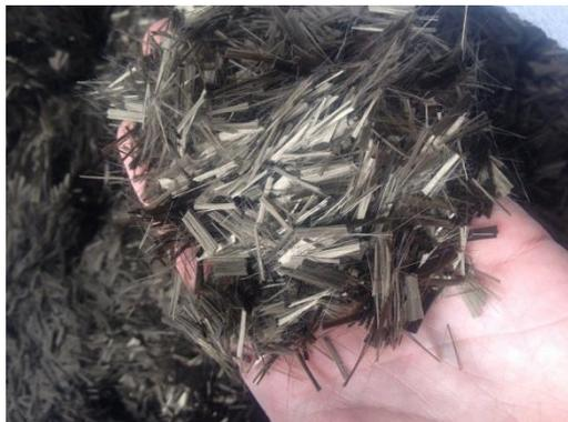
**Базальтовая фибра** – короткие отрезки базальтового волокна предназначенные для армирования вяжущих смесей, типа бетона, в строительстве. Увеличивает марочную прочность бетона, уменьшает расслаивание бетонной смеси, сокращает время первичного и окончательного твердения, снижает массу бетонных изделий.
