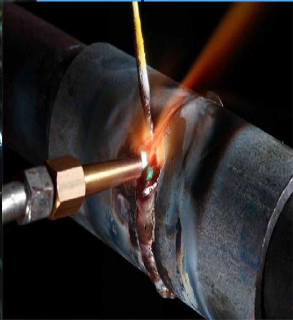
**Детали насосов наплавлиют и растачивают до первоначального размера.**
