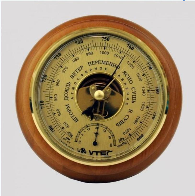
Барометр - прибор для измерения атмосферного давления, изменение которого предвещает перемену погоды.
