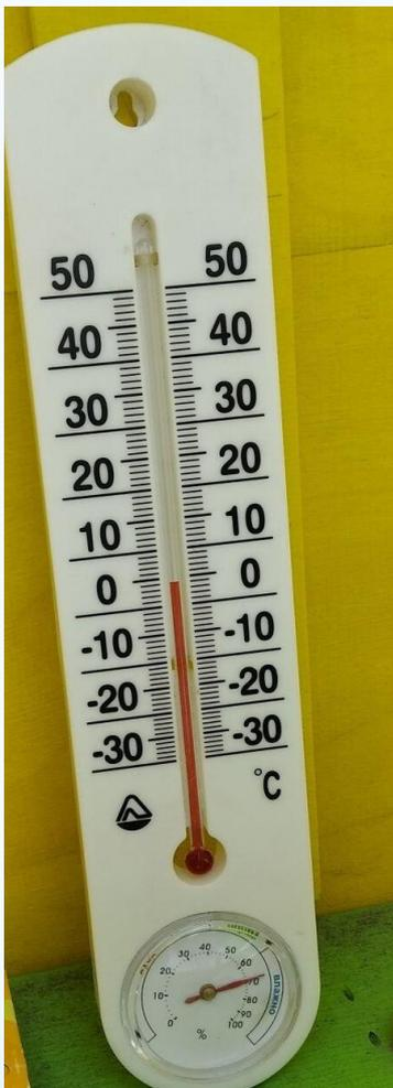
Термометр с гигрометром это прибор измерения температуры и влажности воздуха.
