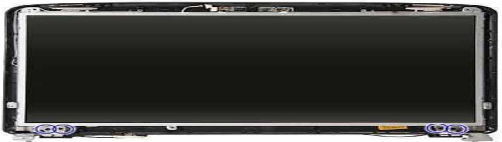
Под матрицей располагаются шлейф вебкамеры и Wi-Fi антенны, отсоединяем его потянув за шлейф, которым он крепится к матрице. Готово – матрица полностью отсоединена от экрана. Производим замену матрицы и собираем ноутбук в обратном порядке.
