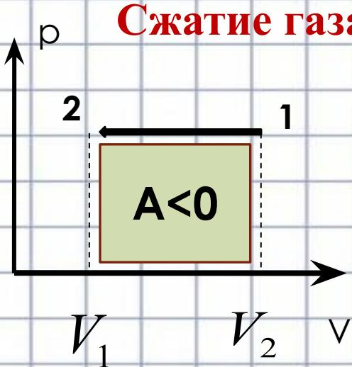
$$A_{\text{Газа}} = p \cdot (V_2 - V_1) = p\Delta V \text{ - работа газа}$$
