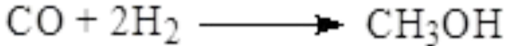
**Рис.4. Схема получения метанола**
