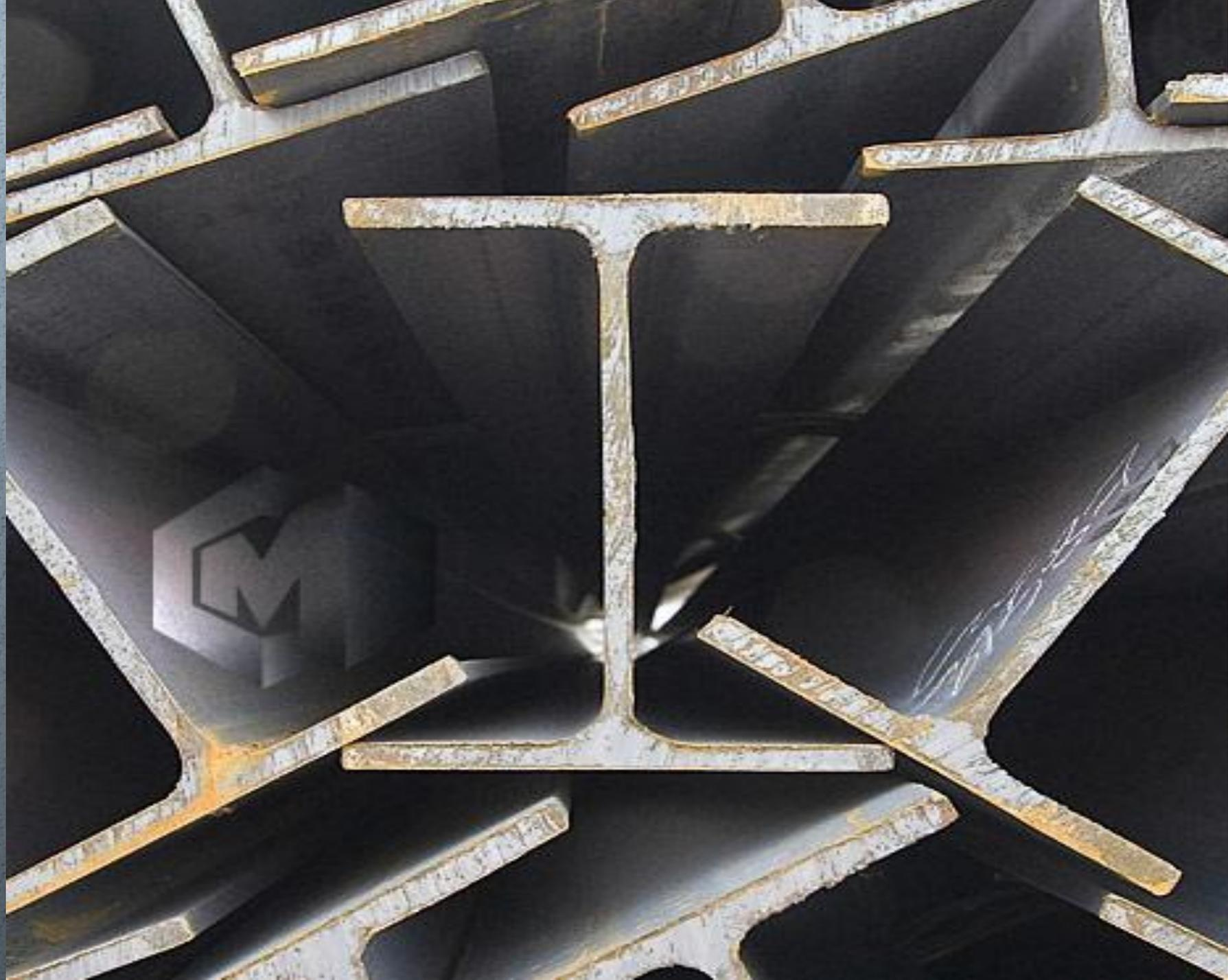
*o* Отсутствие сварных швов в областях контакта полок со стенкой существенно уменьшает концентрацию напряжений и снижает уровень начальной дефектности.
