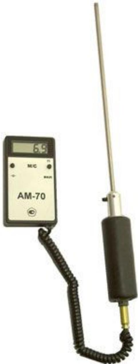
**Предназначен для определения скорости воздушных потоков в открытом пространстве, скорости дымовых газов и газопылевых потоков, отходящих по закрытым каналам от стационарных источников загрязнения.**
