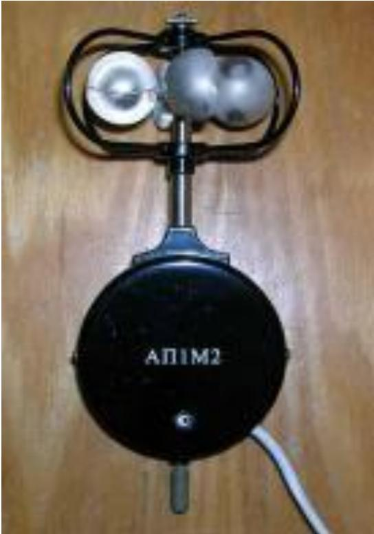
**Назначение:** измерение средней скорости направленного воздушного потока и средней скорости ветра. Область применения – метеорология, строительство, пищевая промышленность, а также промсанитария.
