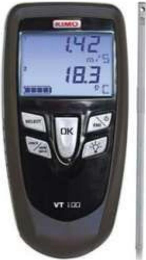
**Предназначен для измерения скорости и температуры воздушного потока, измерения объемного расхода (с воронкой), автоматическое усреднение показаний, функция минимального и максимального значений. Особенности:**
