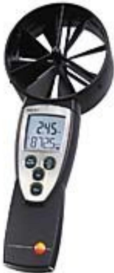
**Предназначен для измерения скорости потока, объемного расхода и температуры. Объемный расход отображается напрямую на дисплее. Точный расчет объемного расхода благодаря тому, что зонд легко совмещается с воздуховодом. В дополнение, легко переключиться на отображение показаний текущей температуры.**
