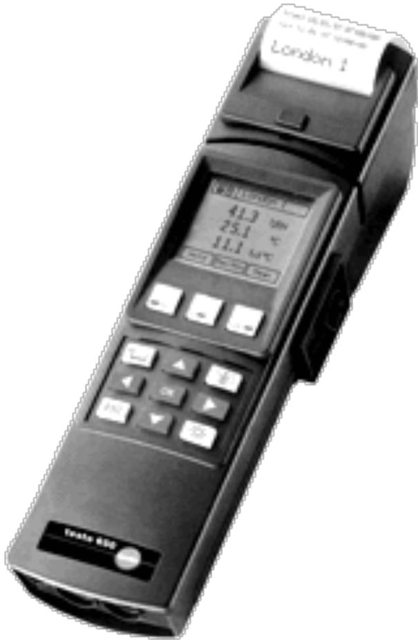
**Портативные измерительные приборы с большим выбором зондов. В максимальной комплектации позволяют измерить температуру, влажность, давление, скорость потока воздуха, концентрацию CO и CO<sub>2</sub>, скорость вращения, напряжение и силу тока. Приборы автоматически идентифицирует тип подключенного зонда и настраивается на соответствующее измерение. Измеренные данные выводятся в цифровом виде на большом ЖК-дисплее. Приборы имеют встроенную память, выход на компьютер и принтер**
