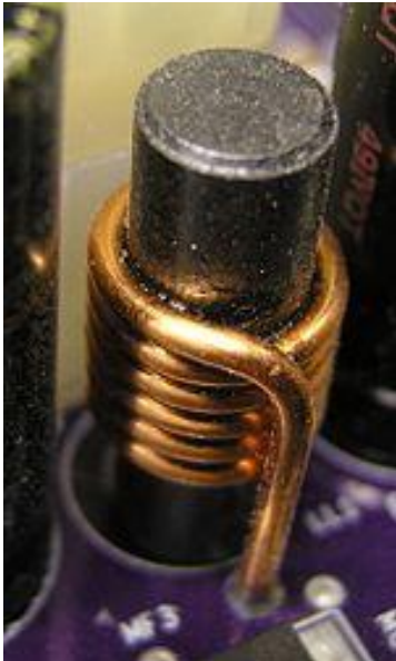
Катушка индуктивности (дроссель) на материнской плате компьютера
