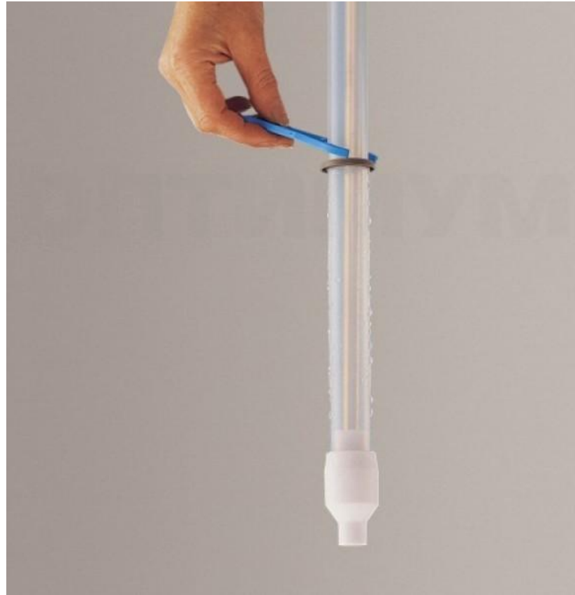
Рис. 3 – Пластиковая трубка для отбора вязких продуктов
