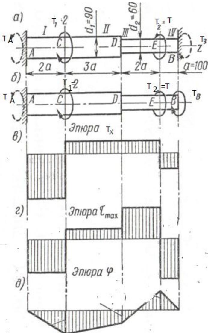
Для составления уравнения перемещений отбросим правую заделку, заменив ее действие на брус не известным пока реактивным моментом  $T_B = X$ . Полученная таким образом статически определимая система (рис.1, б) эквивалентна заданной и, следовательно, угол поворота сечения  $B$  равен нулю:
