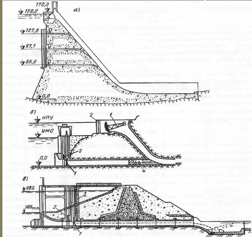
1 – гравитационная плотина с поверхностным и глубинными водосбросами
