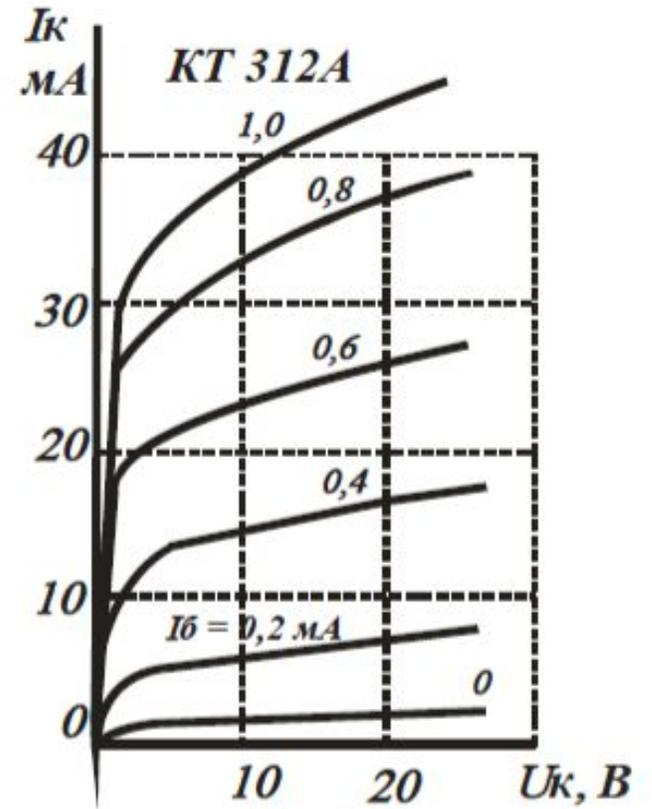
4.28. Используя семейство выходных характеристик транзистора КТ312А в схеме с общим эмиттером (см. рис. 4. 3), определить выходное сопротивление транзистора при токе базы  $I_B = 0,6$  мА и напряжениях на коллекторе  $U_K = 5; 10; 15$  В. Построить график зависимости  $R_{\text{вых}} = f(U_K)$ .
