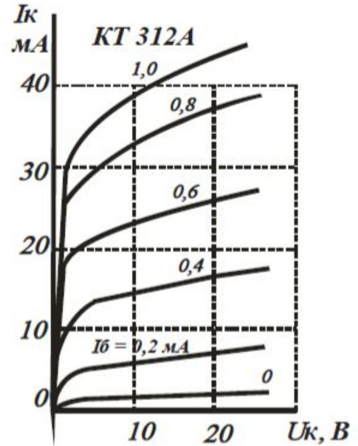
4.22. Для транзистора КТ312А статический коэффициент усиления тока базы  $h_{213} = 10 \div 100$ . Определить, в каких пределах может изменяться коэффициент передачи тока эмиттера  $h_{216}$ .
