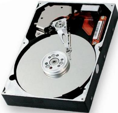
*Дисковые пластины вращаются с постоянной скоростью, которая составляет для современных НЖМД до 10 000 оборотов в минуту. Чтение и запись данных осуществляются блоком магнитных головок, которые расположены над рабочей поверхностью диска на расстоянии 0,5-0,13 мкм. Запись проводится на обе поверхности каждой пластины (кроме крайних).*
