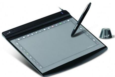
*Дигитайзеры, как правило, используются для ввода карт или планов в ЭВМ. Для этого на графическом планшете размещается лист с изображением, и надавливанием по контуру изображения в компьютер вводятся координаты точек.*
