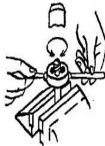
Рис. 54. Нарезание наружной резьбы.
