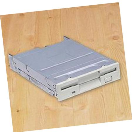
**Гибкий диск ( floppy disk)** - портативный сменный носитель информации, используемый для многократной записи и хранения данных. Представляет собой диск помещённый в защитный пластиковый корпус. Для считывания дискет используется дисковод.
