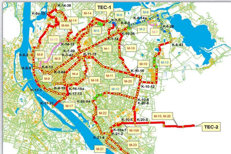
Схема размещения компенсаторов на магистральных тепловых сетях правого берега г.Риги
