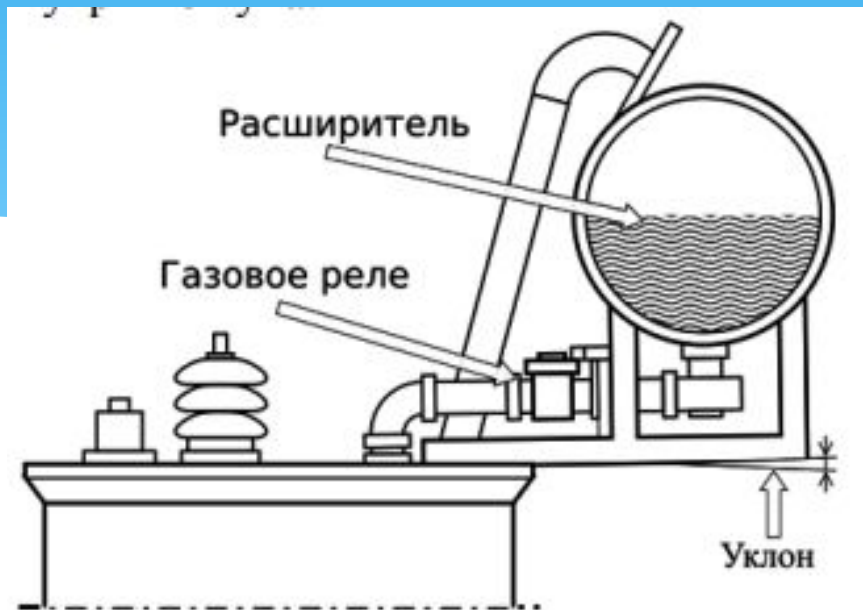
Установка газового реле на трансформаторе
